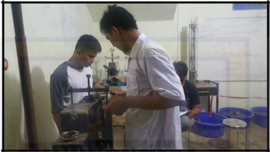
PENGUJIAN SAMPEL KUAT GESER LANGSUNG
