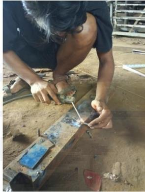
Gambar L.5 Pembuatan Elektroda Pelat Stainless Steel
