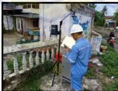
Lampiran 3.12 Pengukuran Lingkungan dengan Parameter Udara Ambien Sumber : Foto Lapangan
