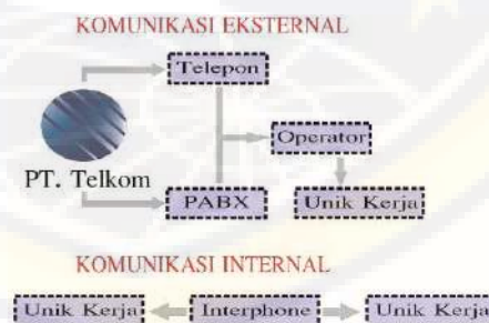
Gambar.20 Sistem Telekomunikasi (Sumber : Penulis, 2020)
