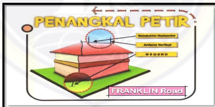
Gambar,6.18 . Sistem penangkal petir
