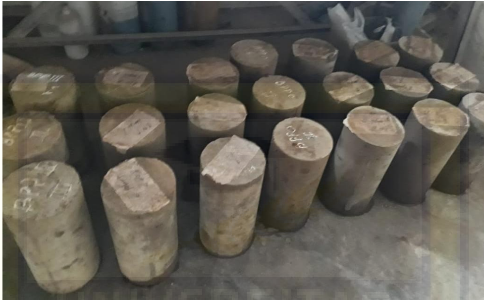
BETON SETELAH PERENDAMAN
