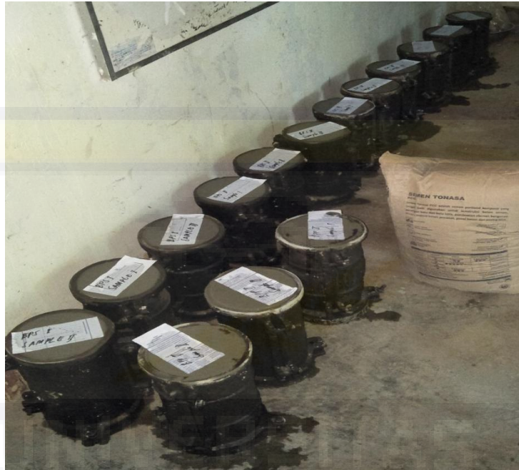
PROSES PENCETAKAN BETON
