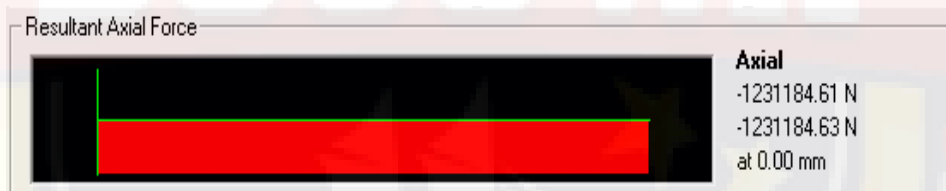
Gambar 4.27 Diagram gaya axial (-) akibat beban gravitasi dan gempa
