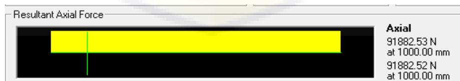
Gambar 4.12 Diagram axial balok akibat beban gravitasi dan gempa
