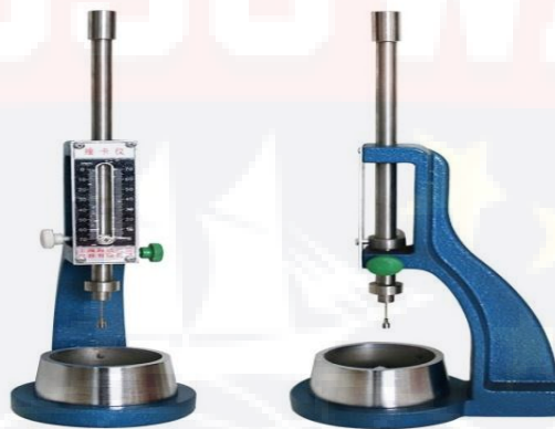
Gambar 2.4 alat pengujian waktu ikat semen (vicat)
