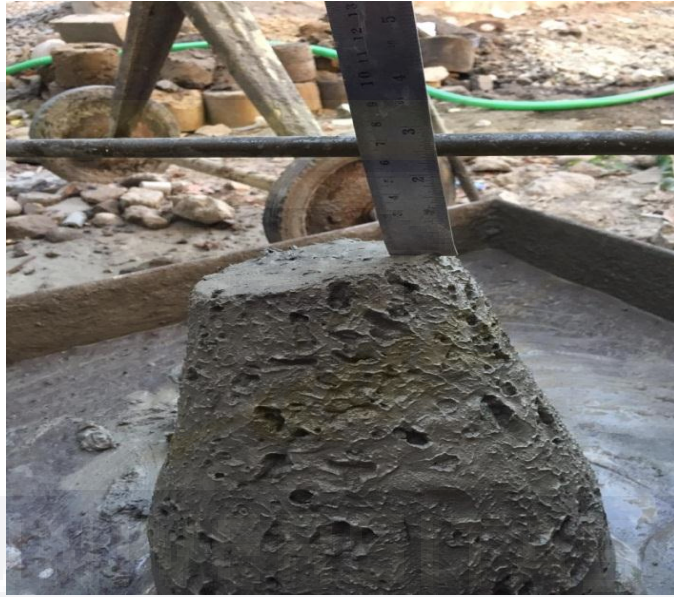
Pengukuran Nilai Slump
