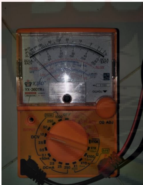
Gambar L.13 Tegangan 0,9 Volt Elektroda stainless steel (jam ke-18)
