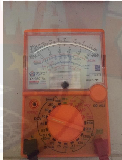
Gambar L.17 Tegangan 1,5 Volt Elektroda stainless steel (jam ke-18)
