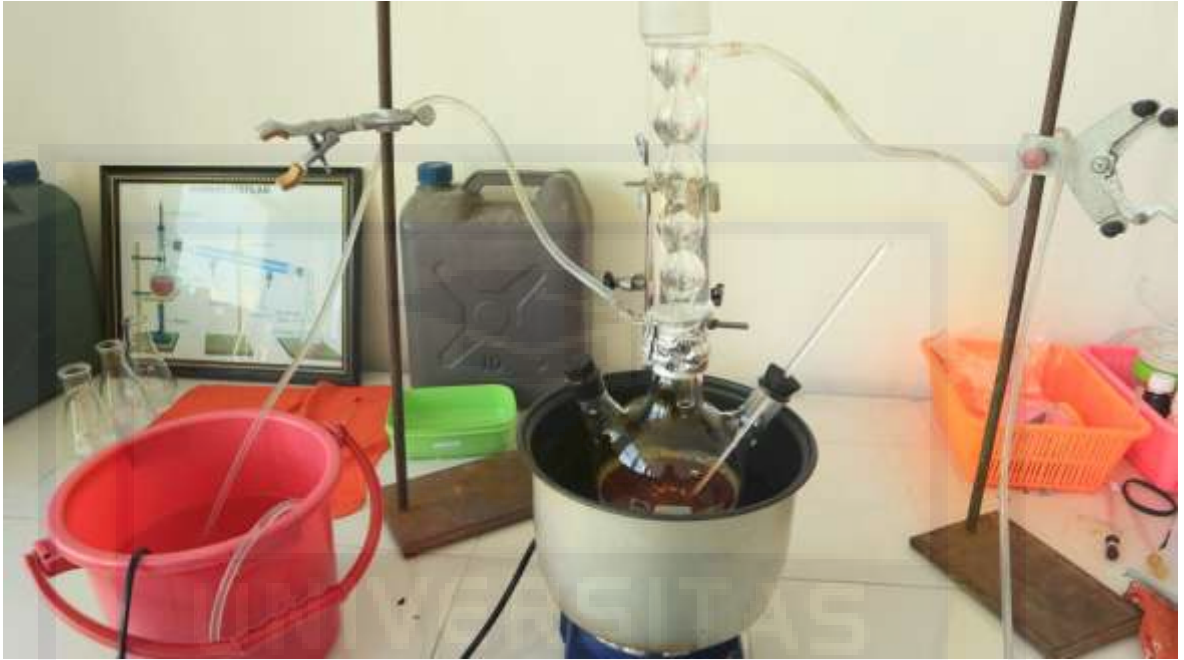
Gambar L.7. Rangkaian alat ekstraksi
