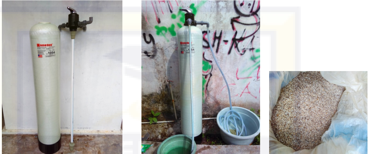
Gambar 1, Perancangan alat filter dengan pasir silika
