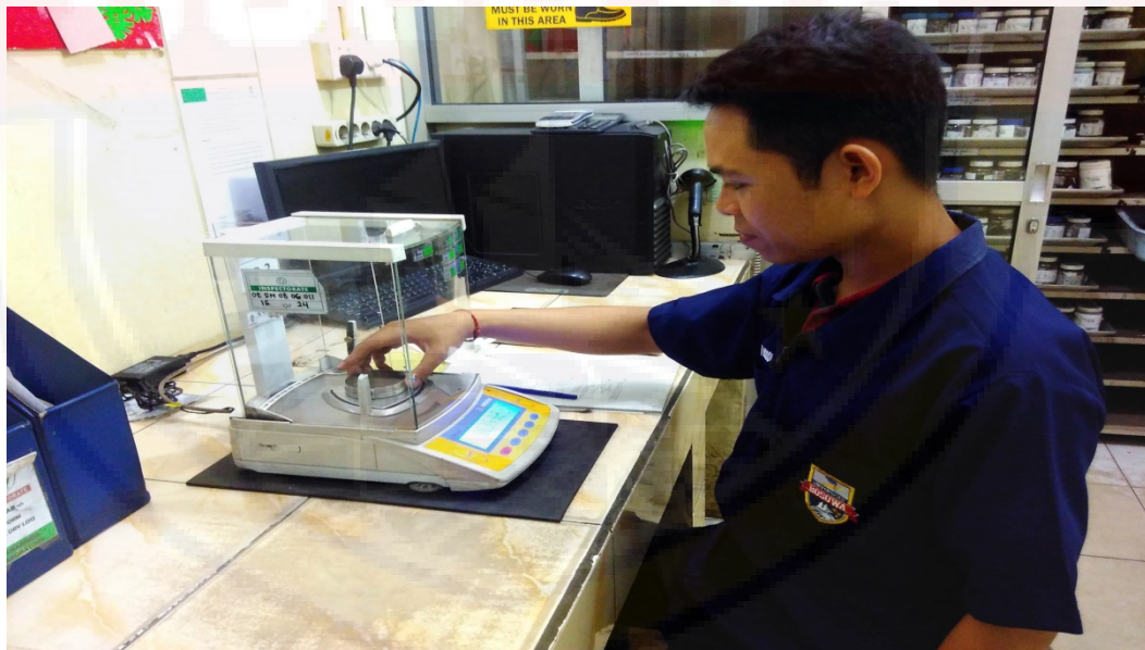
Gambar foto 4, sampel uji TSS ditimbang setelah pemanasan dan
