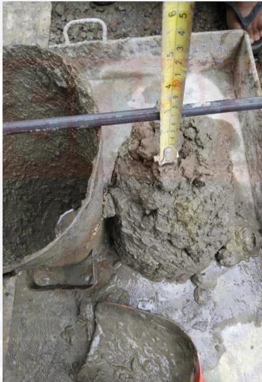
Gambar 4.1 Pengujian nilai *slump* adukan beton segar
