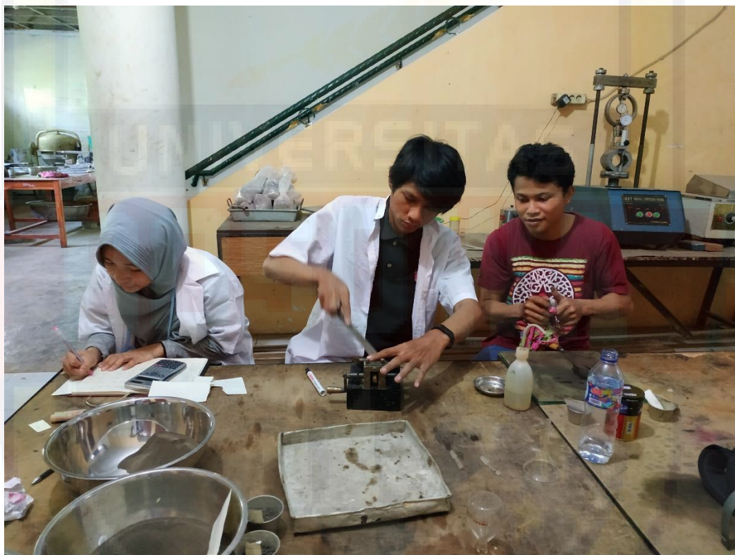
foto 5 Pengujian Batas- Batas Atterberg
