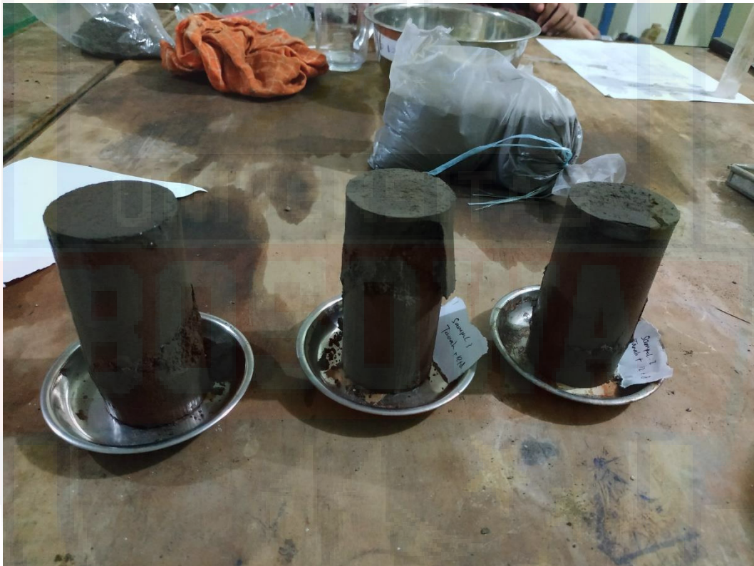
foto 12 Hasil pengujian Kuat Tekan Bebas
