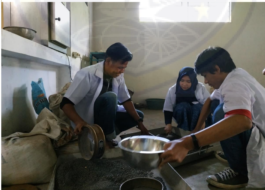
foto 3 penumbukan dan penyaringan tanah
