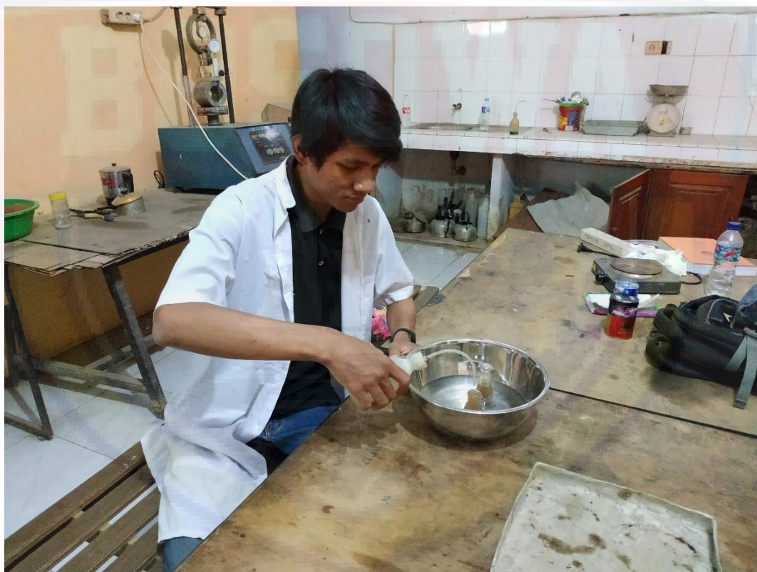
foto 7 Pengujian Batas- Batas Atterberg
