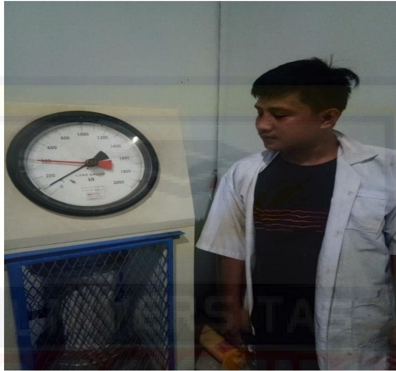
Gambar 13. Pengujian Kuat Tekan Beton
