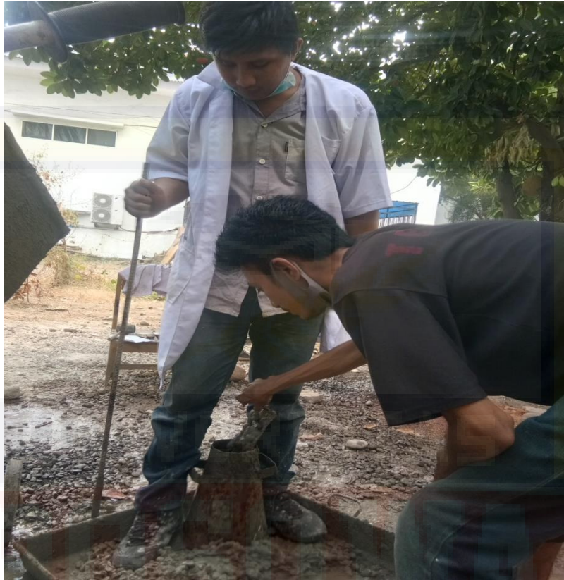
Gambar 9. Pengujian Slump Test
