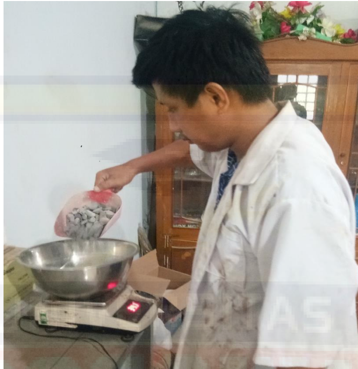
Gambar 5. Penimbangan Agregat Kasar
