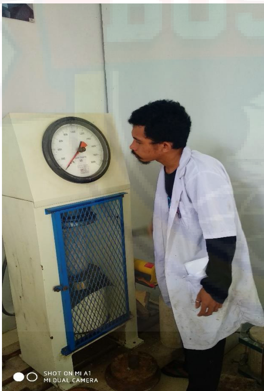
Uji Kuat Tekan Beton
