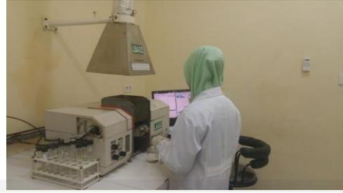
Gambar 6. preparasi sampel dan pembacaan sampel pada alat AAS GBC Prospector
