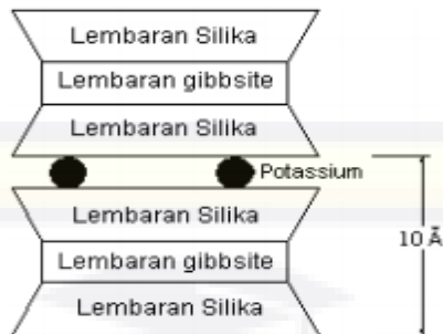
Gambar 2.5 Struktur illite (Das Braja M, 1988)
