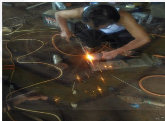
Gambar 3 pengelasan pedal penggerak
