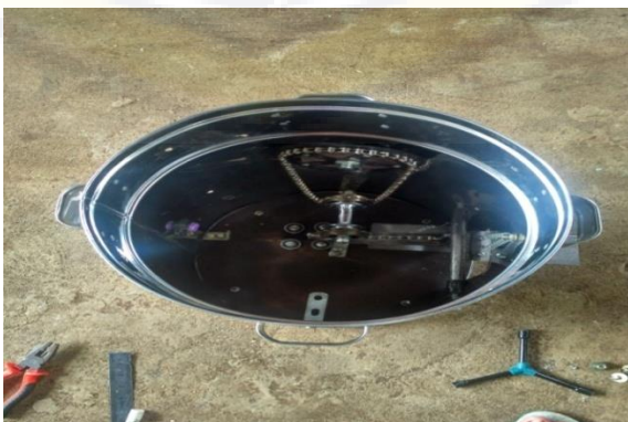
Gambar7 pemasangan rantai dan gear penggerak
