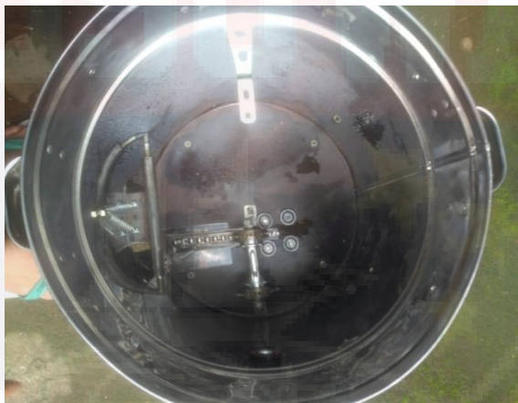
Gambar6 pemasangan kedudukan pedal
