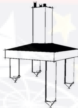
Gambar VI. 21: Pondasi Ting Pancang Sumber: Wilson Makgret, 2004: 6
