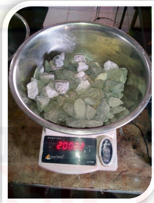
Penimbangan Sampel Untuk Analisa Saringan
