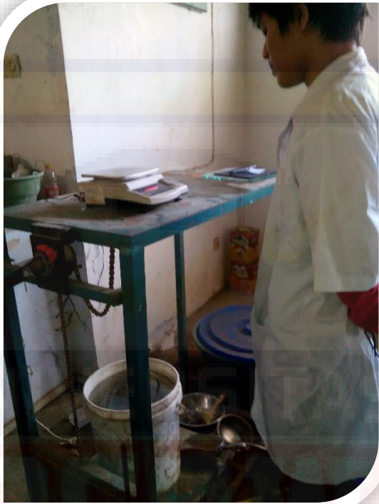
Pengujian Berat Jenis Agregat Kasar
