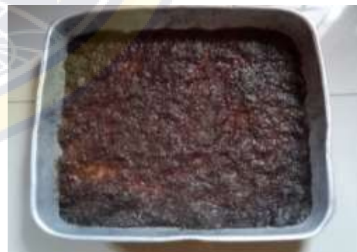
Gambar L.5. Pencetakan Pulp Sebelum Proses Pengeringan Dengan Oven.
