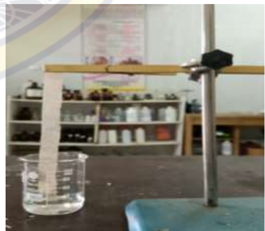
Gambar L.18. Uji Daya Serap Air.
