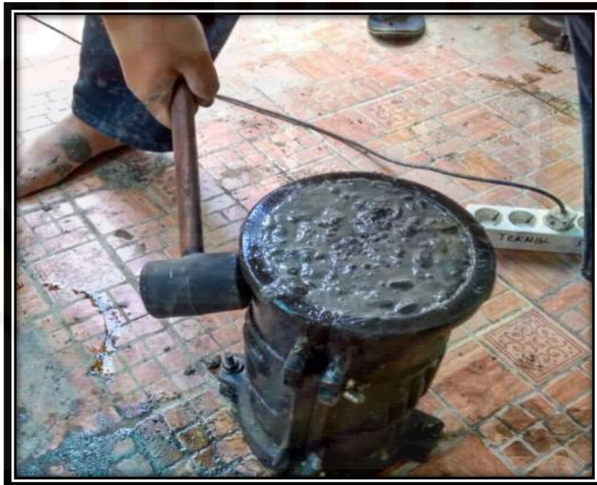
Gambar 16. Pemadatan Dengan Cara Pemukulan Menggunakan Palu Karet
