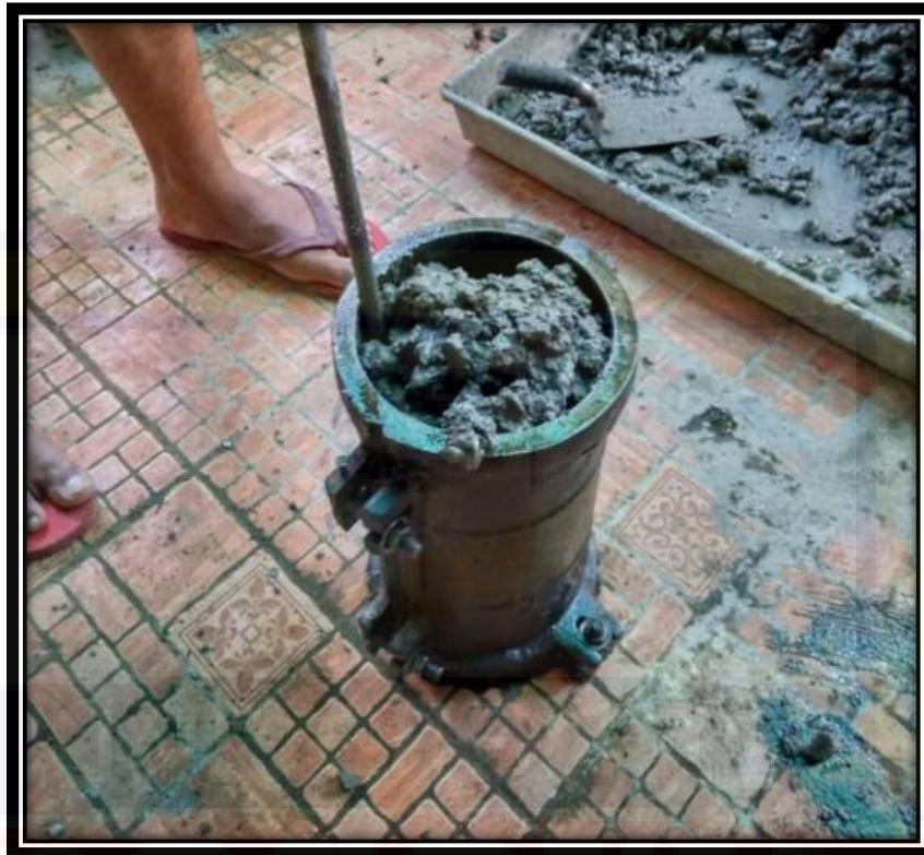
Gambar 15. Pemadatan Beton Dengan Cara Penusukan
