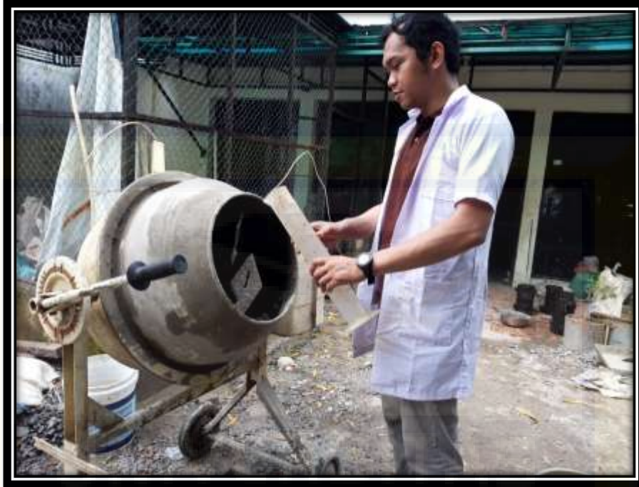
Gambar 13. Proses Pencampuran Beton
