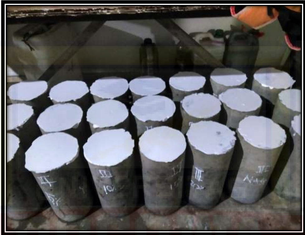
Gambar 19. Pengeringan dan Capping Beton Setelah Perendaman
