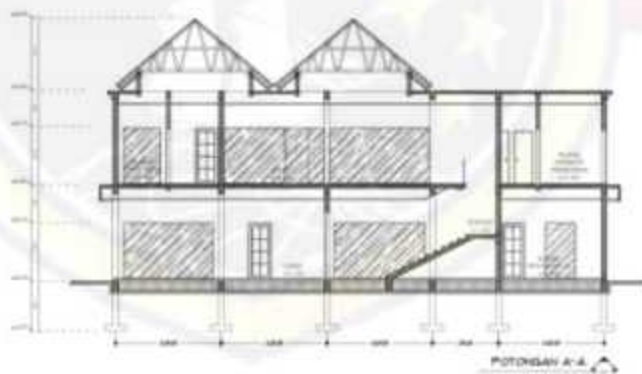
Gambar 3.22 : Potongan bangunan utama
