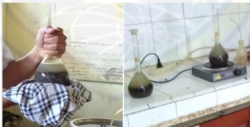
Gambar 3. 4 Pengujian Berat Jenis Agregat Halus
