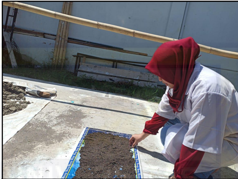
Gambar 4.9. Keringkan benda uji hingga tercapai SSD
