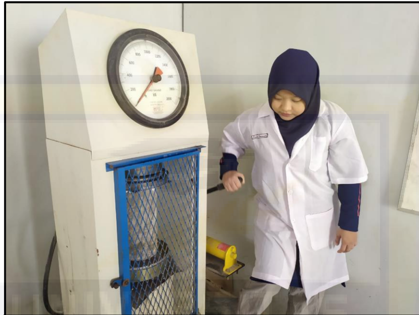
Gambar 4.45. Pengujian kuat tekan beton variasi
