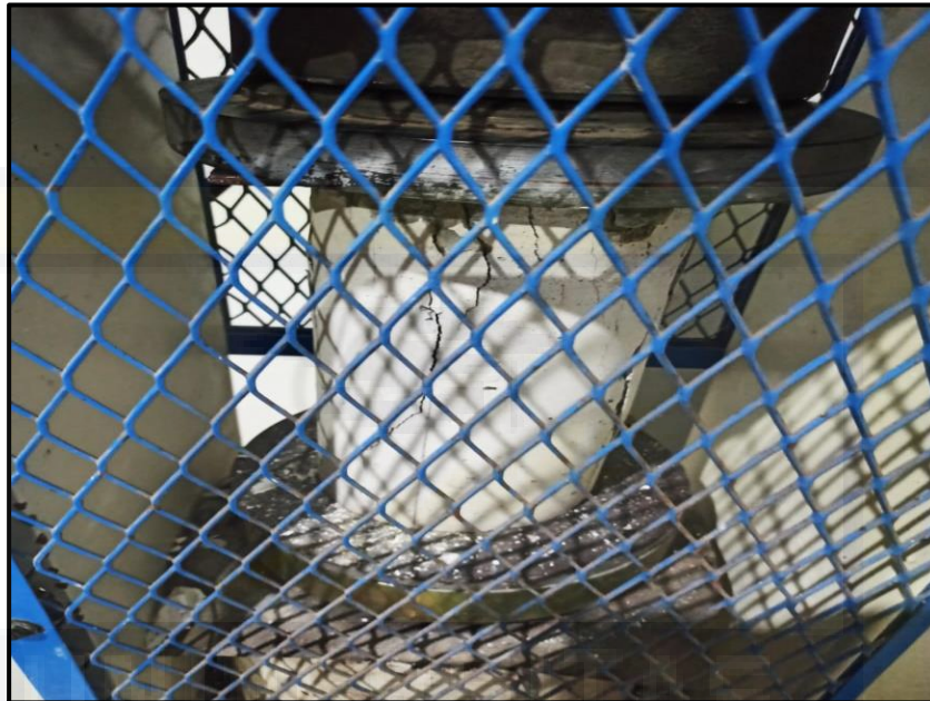
Gambar 4.27. Proses pengujian kuat tekan beton normal
