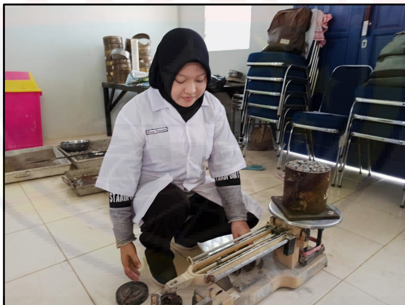
Gambar 4.16. Menimbang benda uji (agregat kasar)
