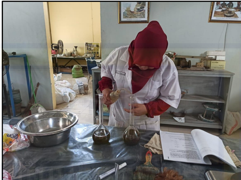
Gambar 4.11. Masukkan benda uji dan air suling kedalam picnometer
