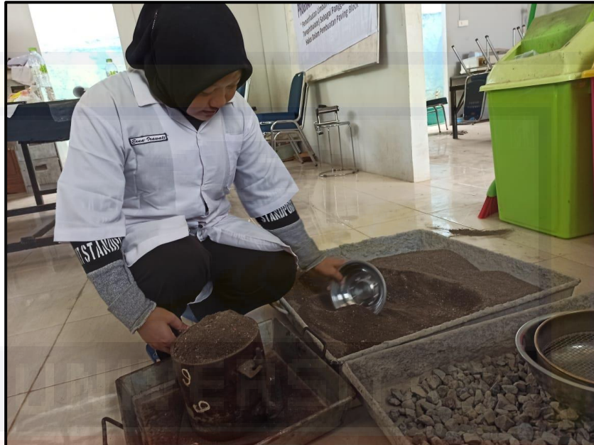
Gambar 4.13. Mengisi mould dengan benda uji
