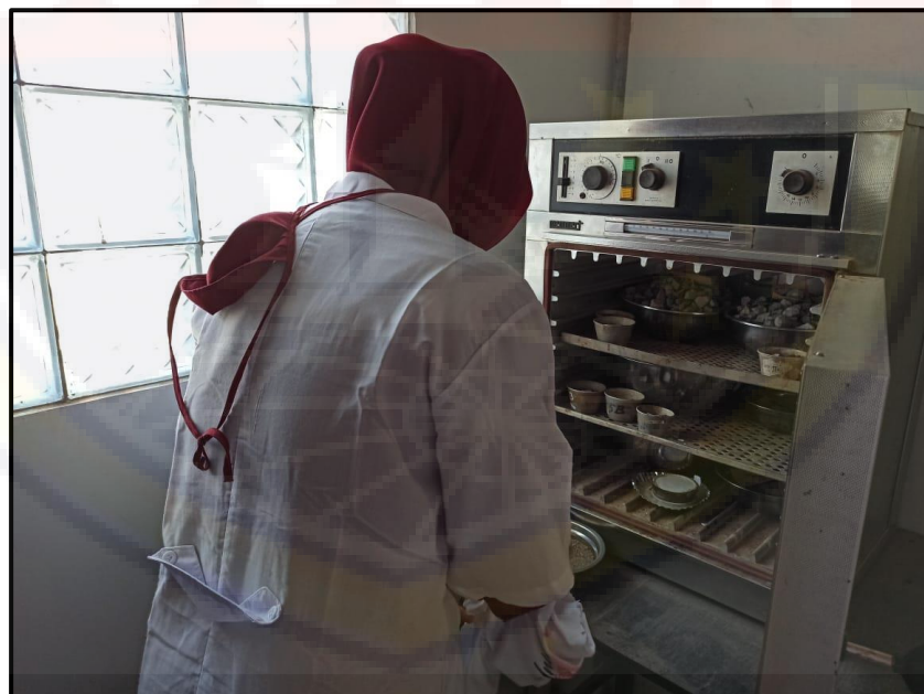
Gambar 4.8. Masukkan benda uji ke dalam oven
