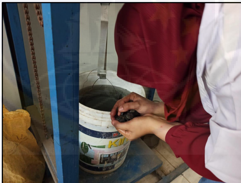
Gambar 4.6. Menimbang benda uji dalam air
