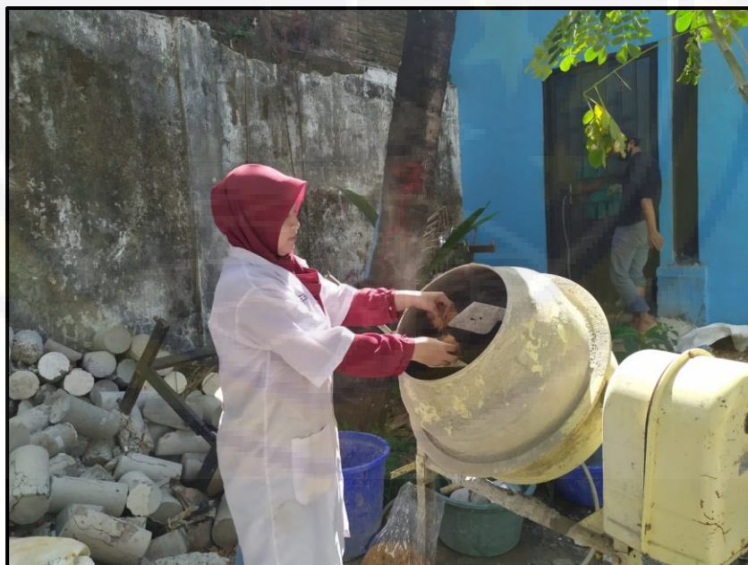
Gambar 4.38. memasukkan serat sabut kelapa ke dalam campuran beton
