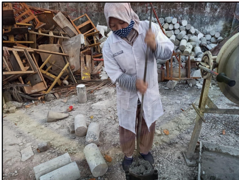
Gambar 4.24. Memasukkan adukan beton kedalam silinder
