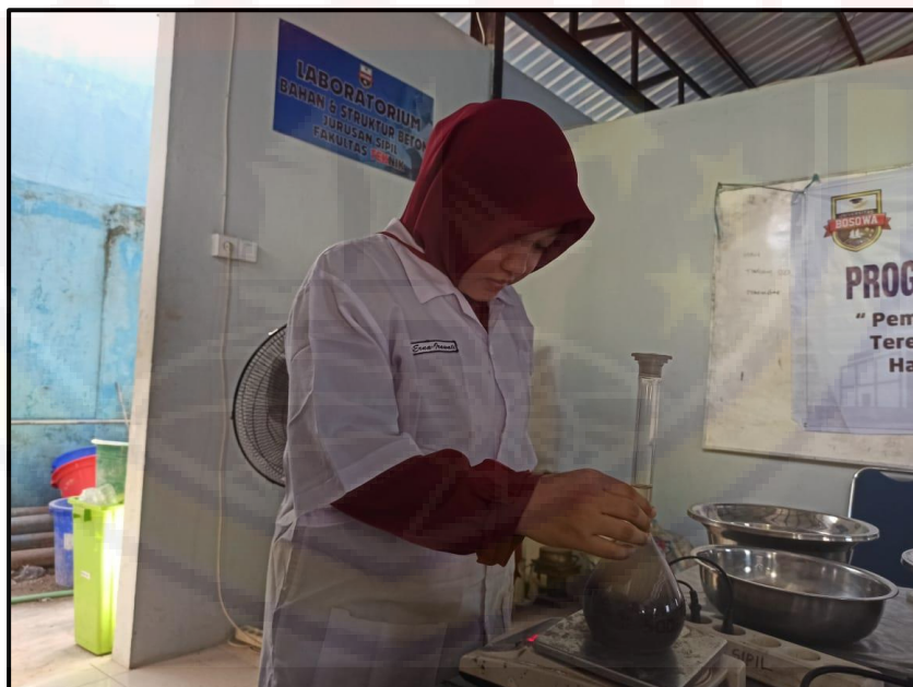
Gambar 4.12. Menimbang picnometer yang berisi benda uji dan air suling
