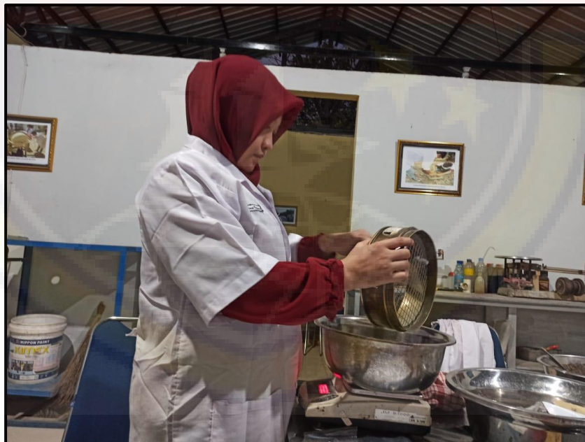
Gambar 4.4. Menimbang benda uji yang lolos saringan
