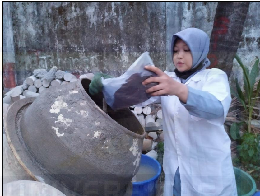
Gambar 4.39. memasukkan ampas kopi ke dalam campuran beton
