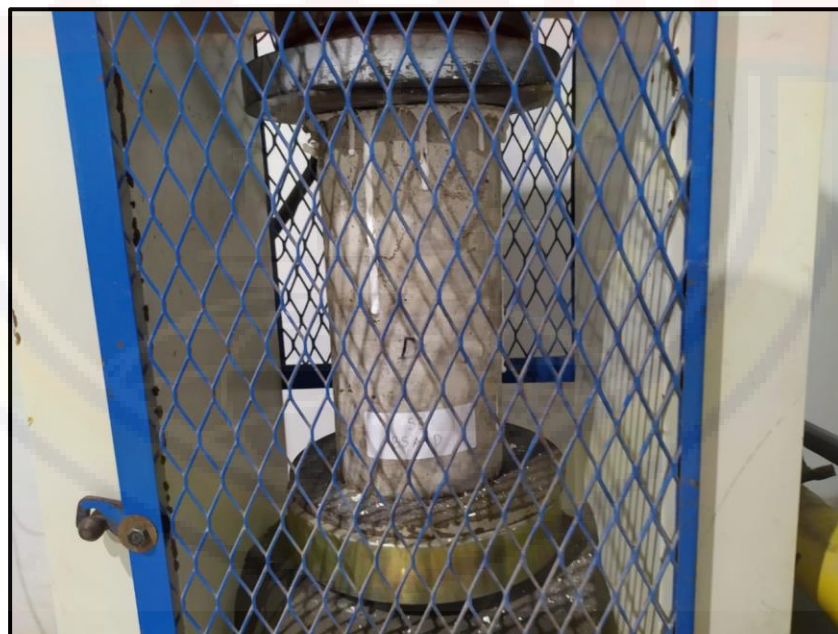
Gambar 4.46. Proses pengujian kuat tekan beton variasi
