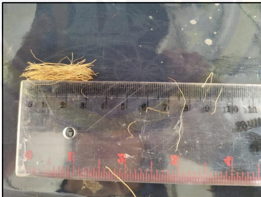
Gambar 4.30. Potongan serat sabut kelapa ukuran 3 cm
