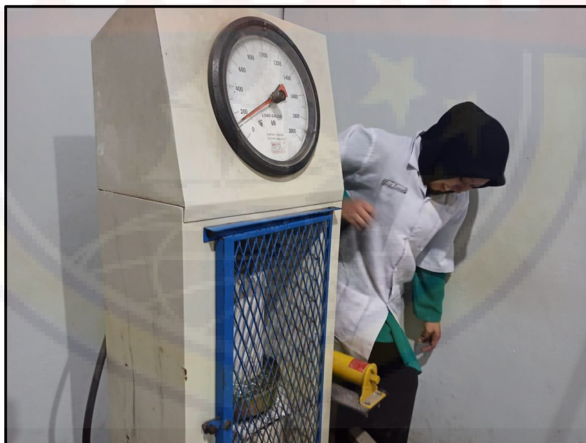
Gambar 4.26. Pengujian kuat tekan beton normal
