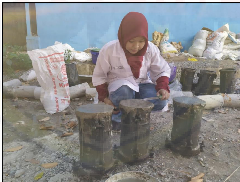
Gambar 4.42. Meratakan campuran beton
