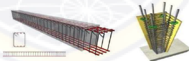
Gambar V, 27 Balok Beton Dan Kolom Beton
