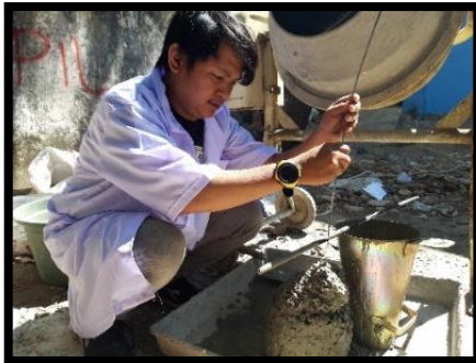
Fig.1. Slump test Apparatus
