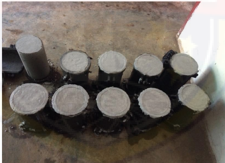
Gambar 8. Proses Pengeringan Sampel Beton Selindir Selama 24 Jam
