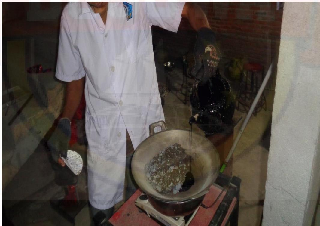
Pencampuran Agregat + Aspal Pen 60/70 dan Asbuton LGA
