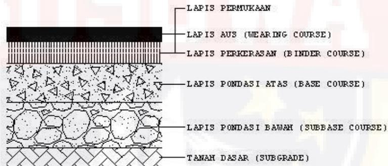
**Gambar 2.2. komponen perkerasan lentur**
