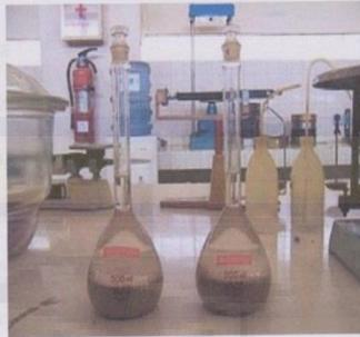
**Gambar 3.4. Pengujian Berat Jenis Agregat Halus**
