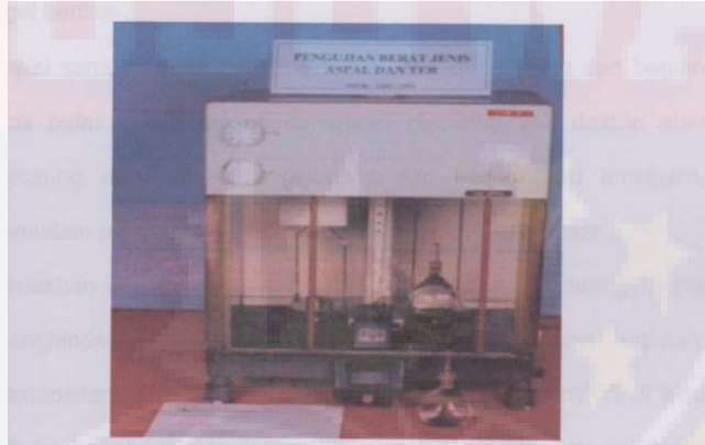
Gambar 3.5. Pengujian Berat Jenis Aspal
