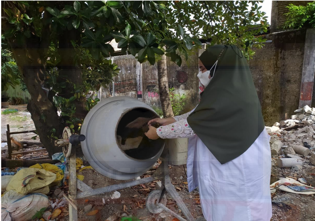
Gambar 11. Proses Penambahan Ijuk Pada Campuran Beton
