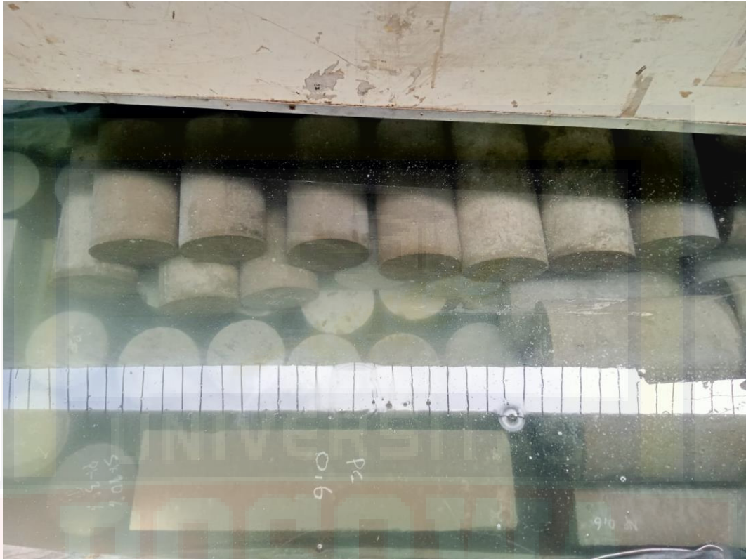
Gambar 9. Proses (Perawatan) Perendaman Beton Selama 28 Hari
