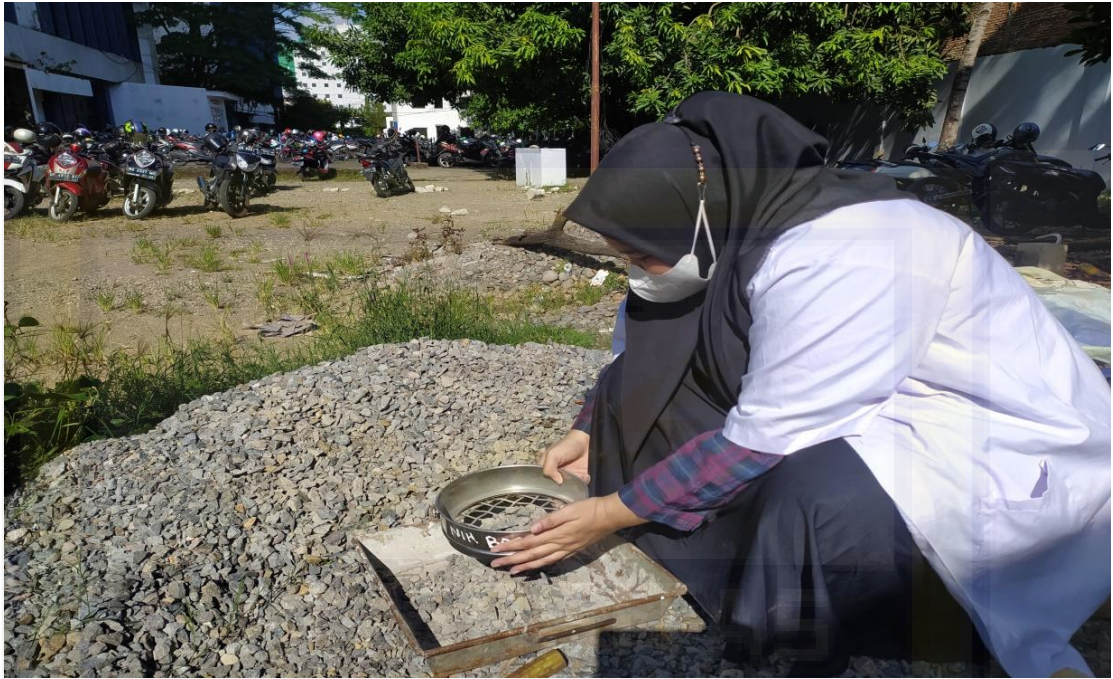
Gambar 5. Penyaringan Agregat Kasar Menggunakan Saringan \frac{3}{4}
