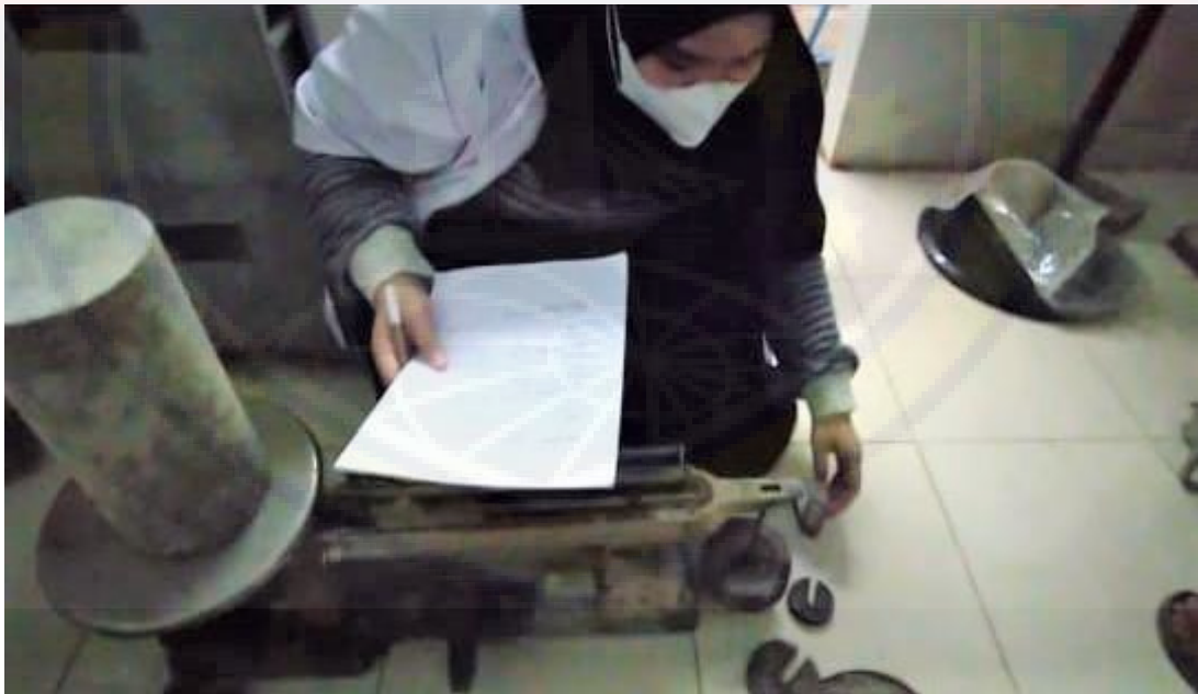
Gambar 10. Proses Penimbangan Sampel Yang Telah Direndam Selama 28 Hari
