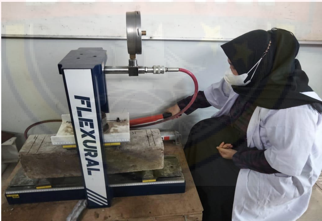
Gambar 14. Proses Pengujian Kuat Lentur Beton
