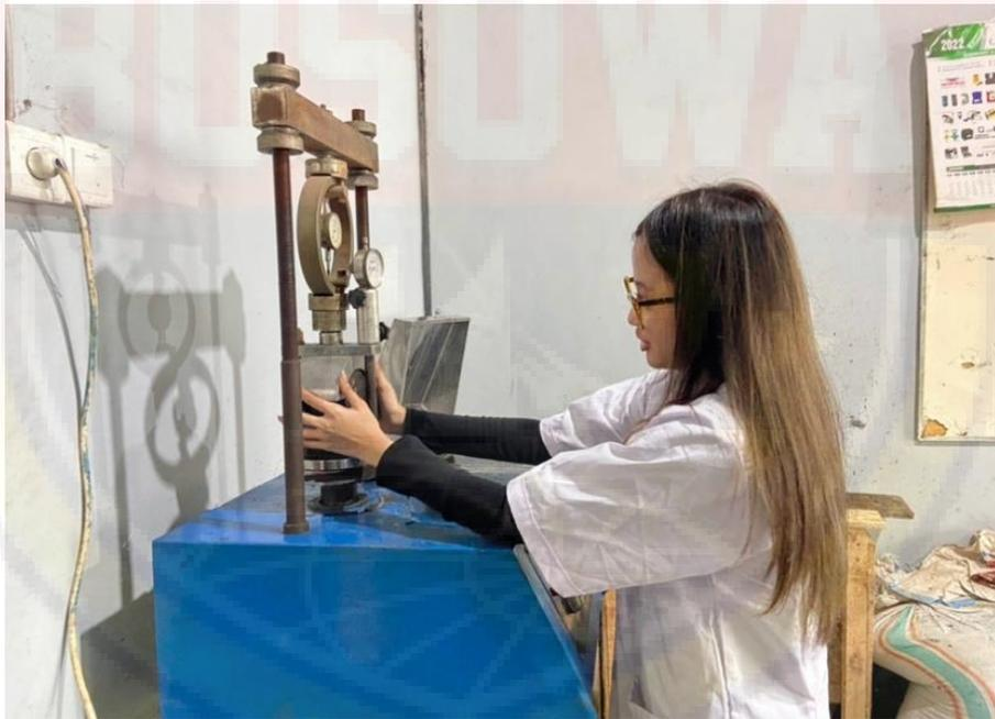
Pengujian Marshall Test
