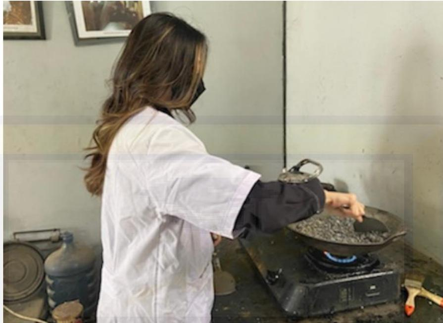
Proses Pencampuran Agregat
