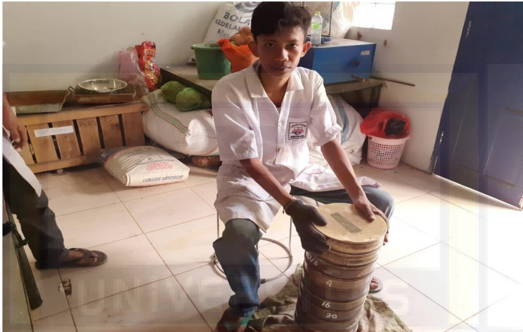
Pengujian Analisa Saringan
