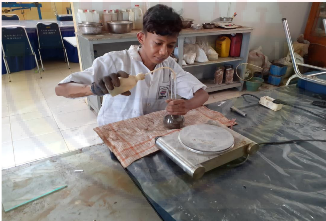
Pengujian Berat Jenis Agregat Halus
