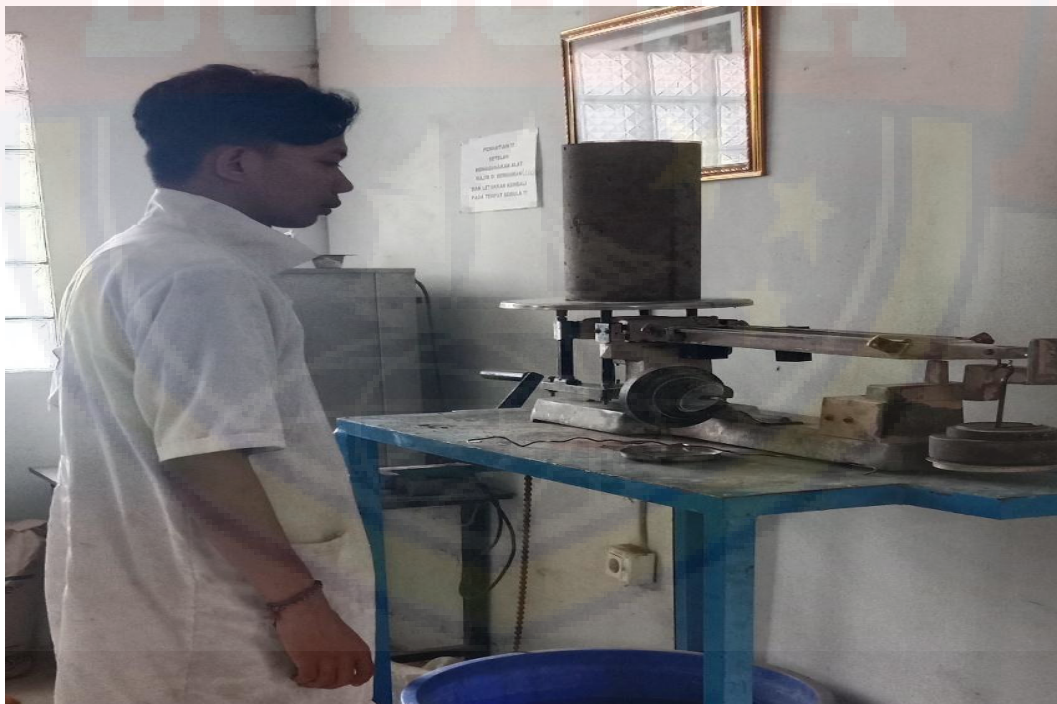
Proses Penimbangan Benda Uji Setelah Perendaman
