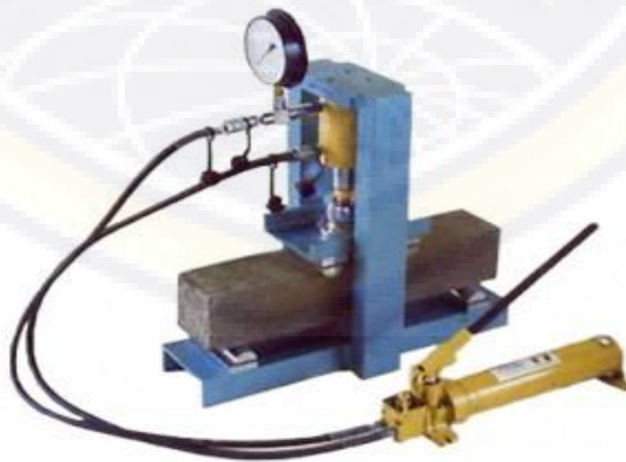
Gambar 2.7 Pengujian Kuat Lentur
