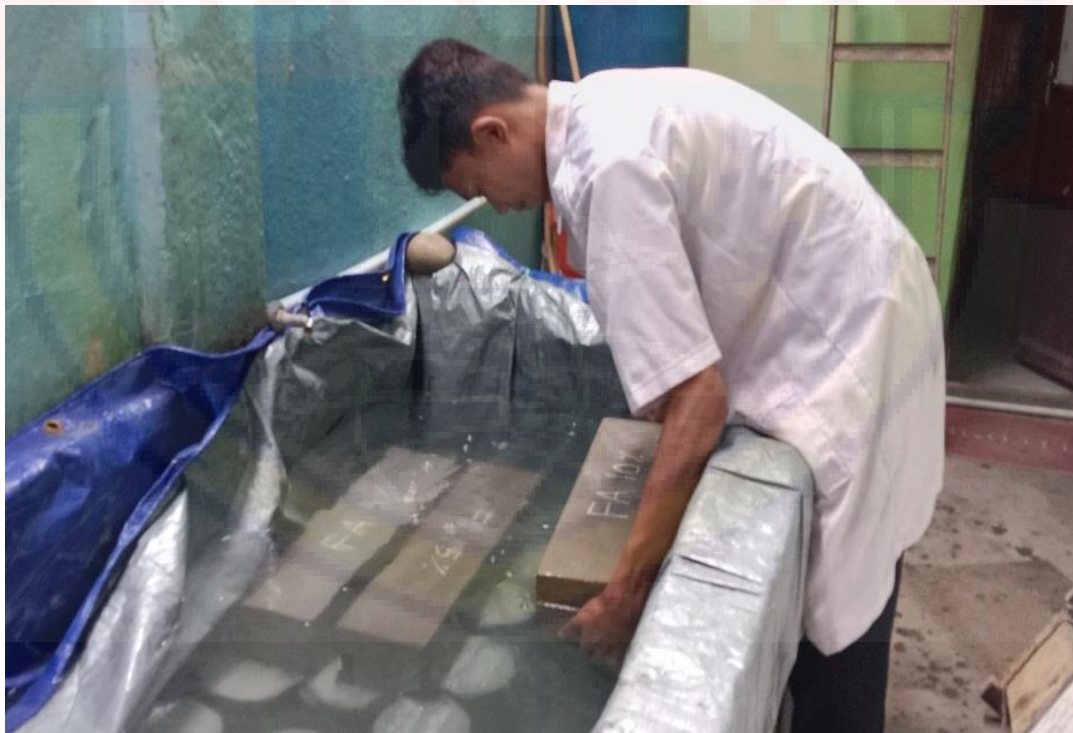
Proses Perendaman Benda Uji Balok
