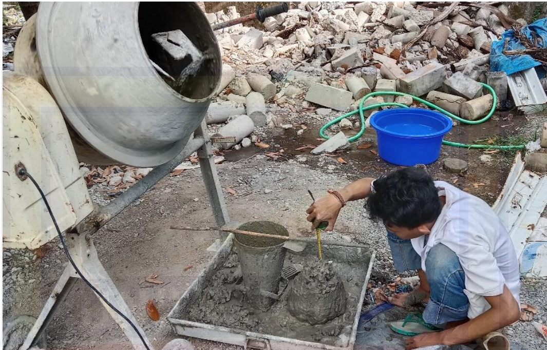
Proses Penghitungan Nilai Slum
