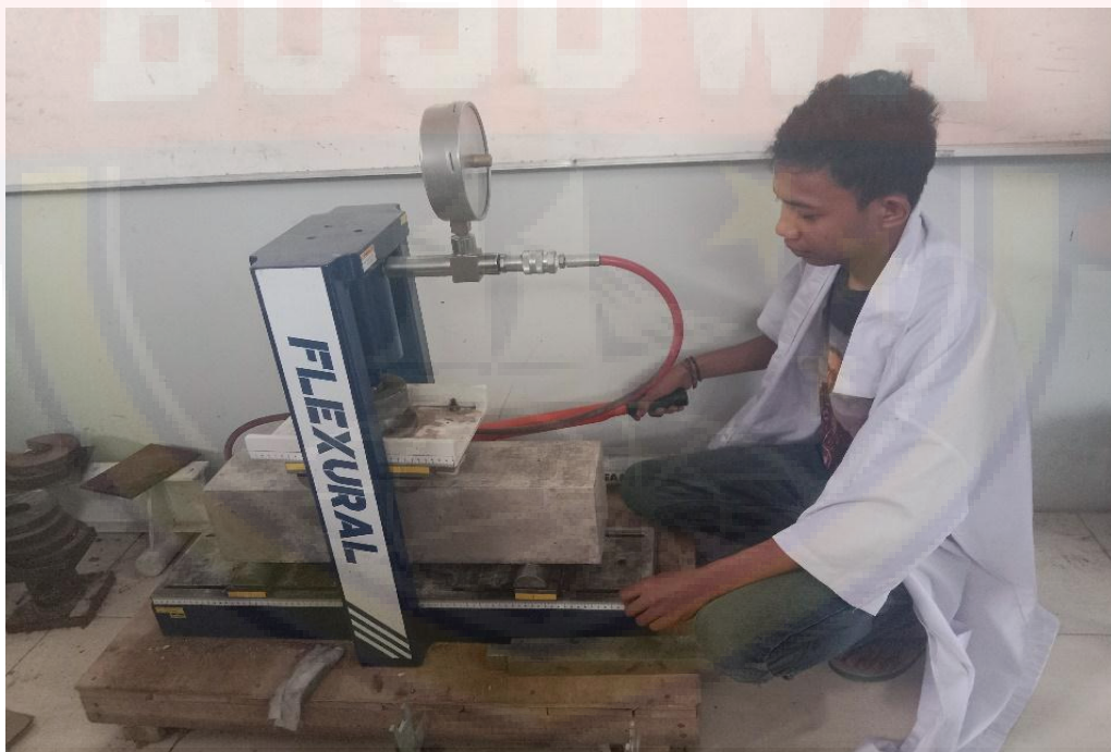
Proses Pengujian Kuat Lentur
