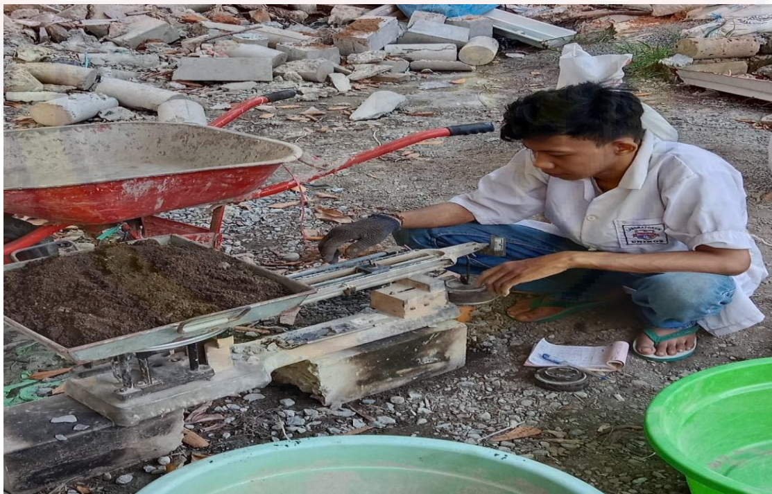
Proses Penimbangan Agregat Halus
