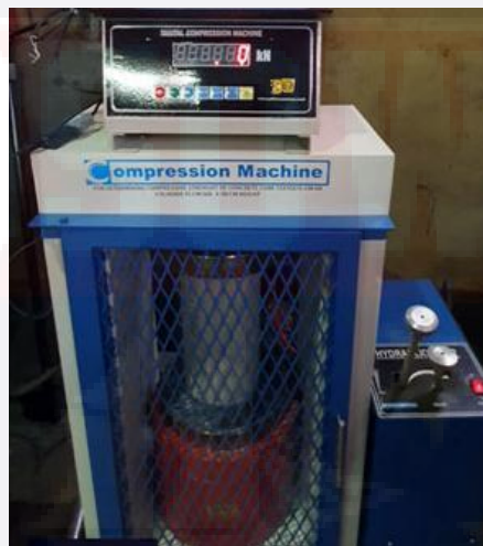
Gambar 2.4 Pengujian Kuat Tekan Beton
