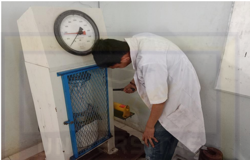
Proses Pengujian Kuat Tekan
