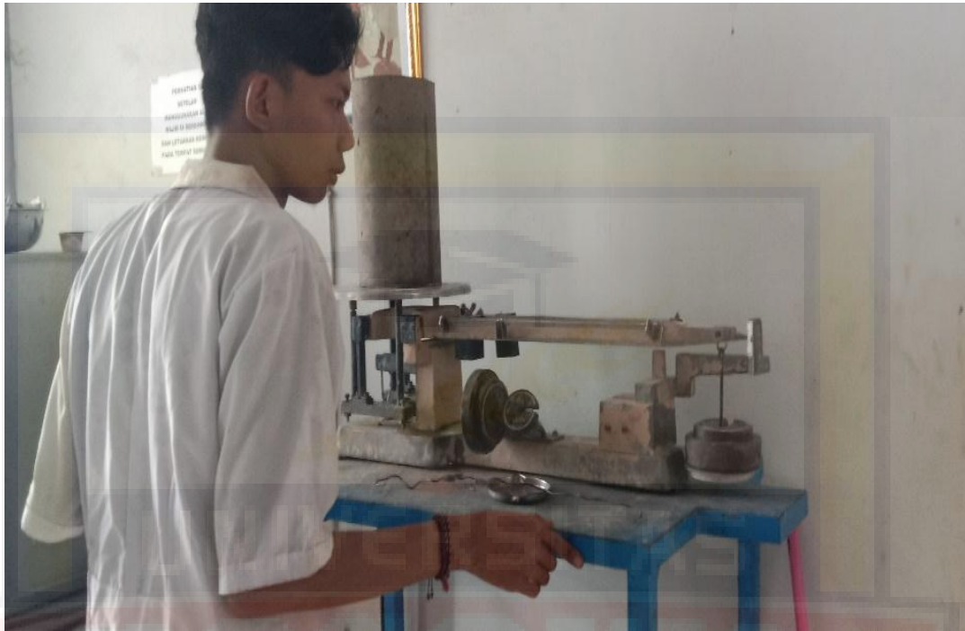
Proses Penimbangan Benda Uji Sebelum Perendaman
