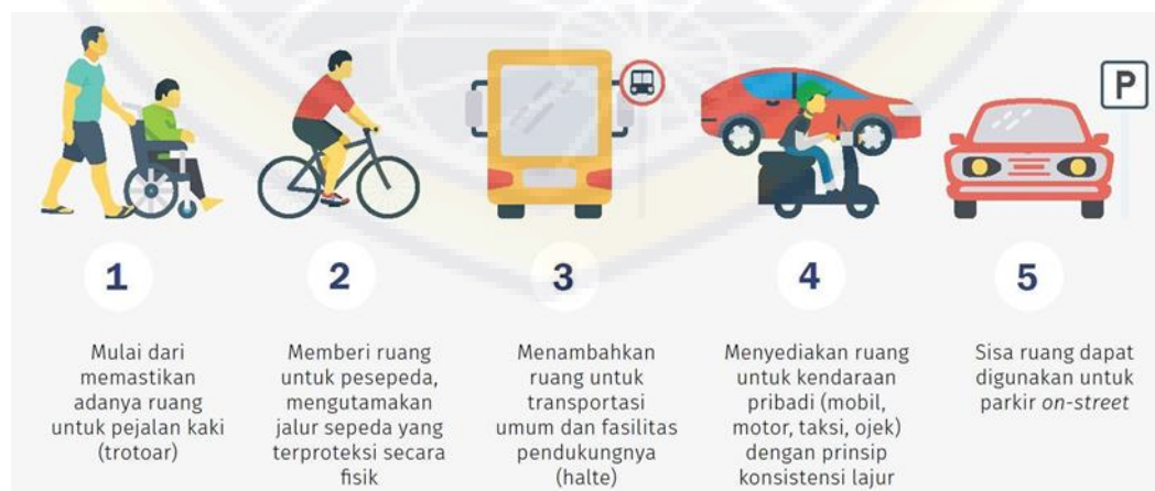
Gambar 2. 1 Potongan Melintang Jalan Ideal dalam Kota
