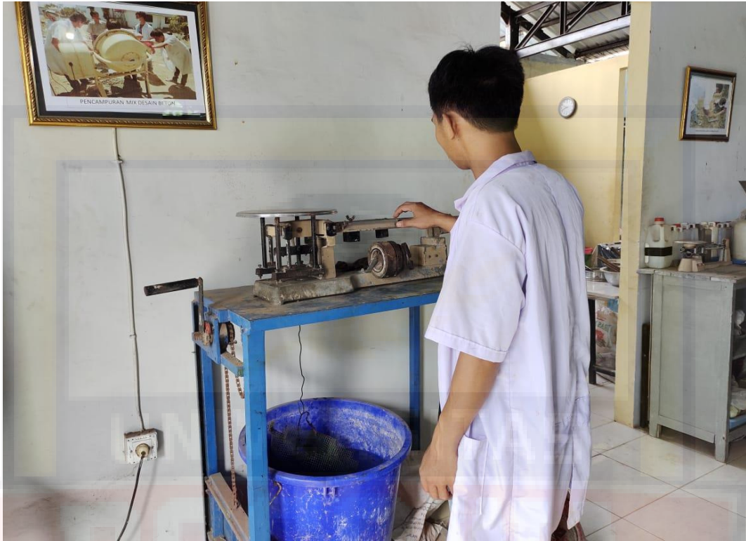
PENGUJIAN BERAT JENIS AGREGAT KASAR
