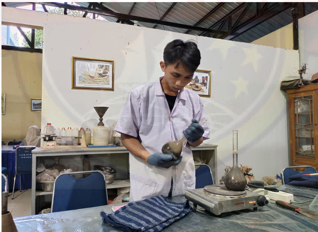
PENGUJIAN BERAT JENIS AGREGAT HALUS
