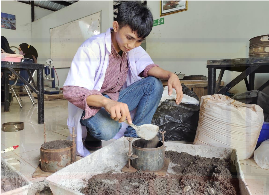
PENGUJIAN BERAT ISI AGREGAT HALUS
