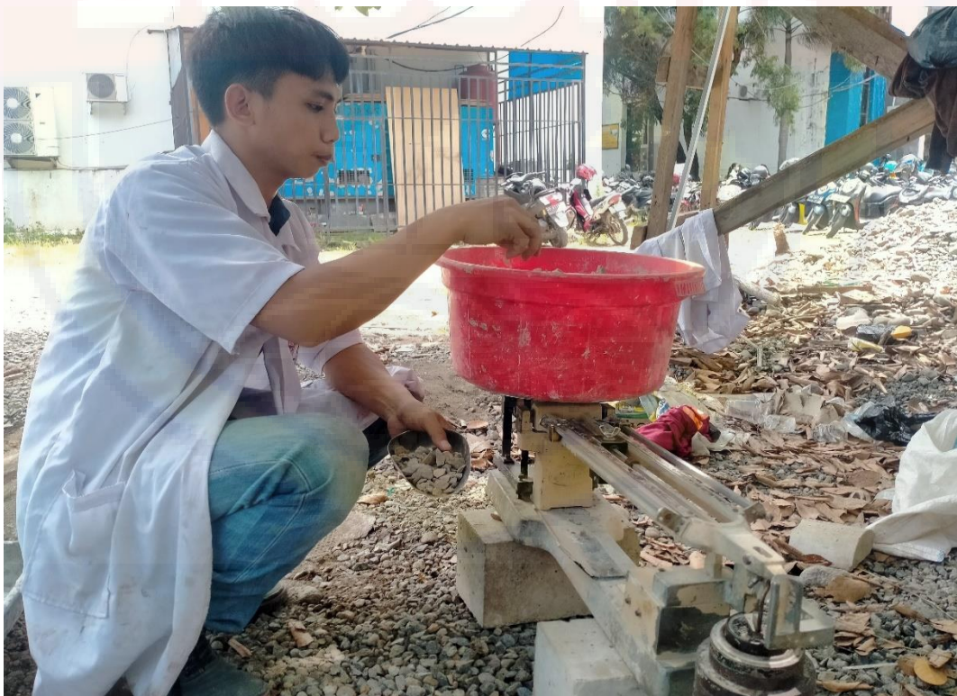
PROSES PENIMBANGAN MATERIAL SETELAH MIX
