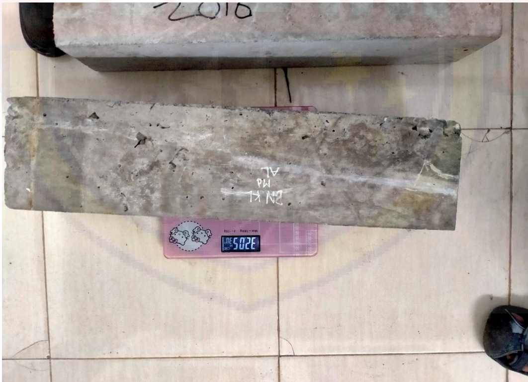
PENIMBANGAN BENDA UJI
