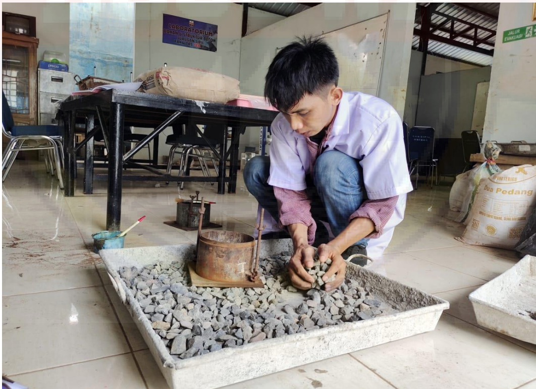
PENGUJIAN BERAT ISI AGREGAT HALUS
