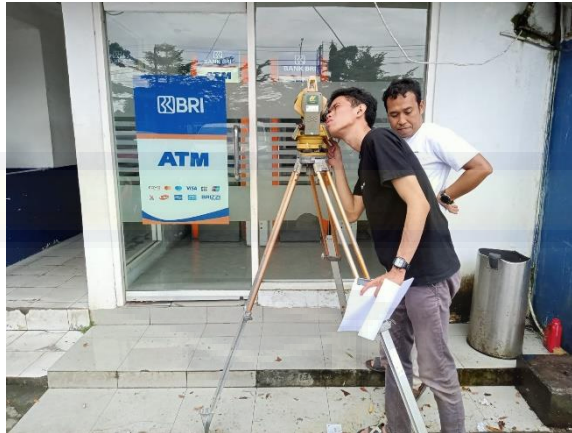
Foto : Penggunaan Alat Total Station Untuk Mengetahui Sudut Kemiringan Gedung Kampus I Universitas Bosowa
