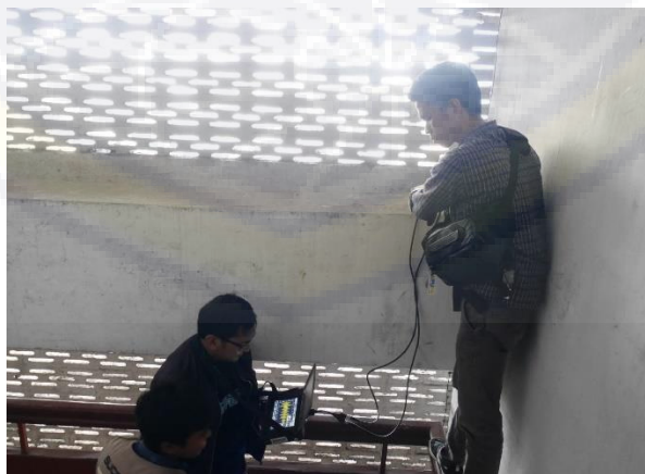
Foto : Pegujian UPV Pundit Titik Balok Beton Gedung Kampus I Universitas Bosowa
