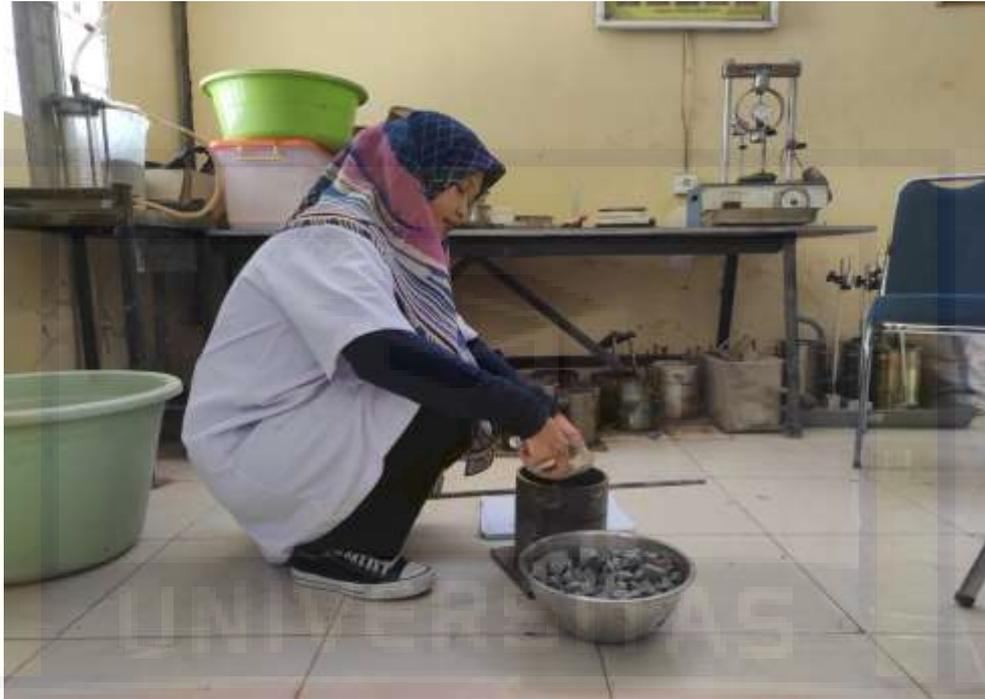
Proses Memasukkan Agregat ke dalam Mold untuk Pengujian Berat Isi
