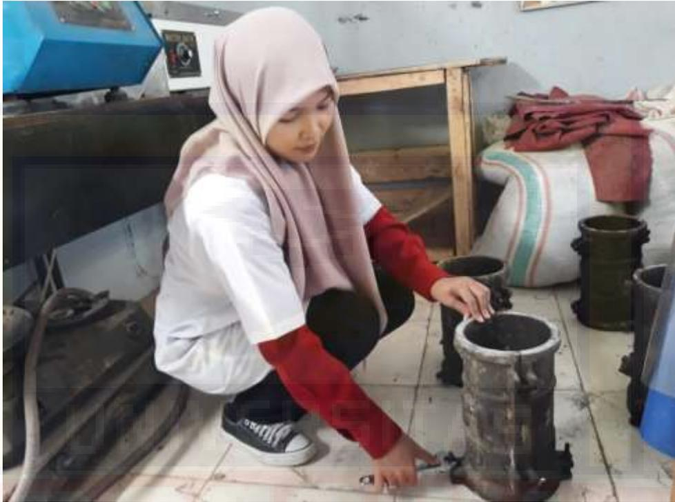
Proses Penyiapan Silinder untuk Pencampuran Beton
