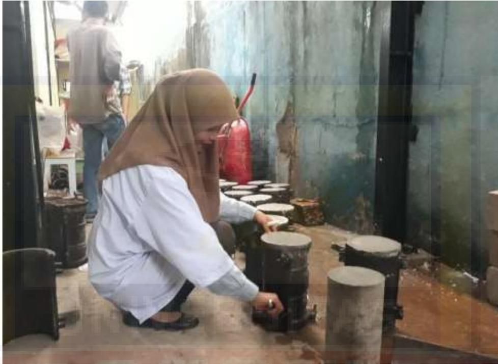
Proses Pelepasan Silinder untuk Proses Perendaman 28 hari
