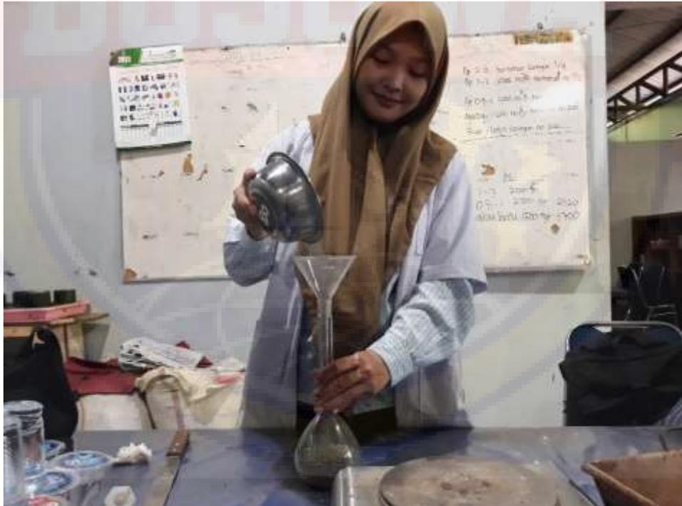
Proses Memasukkan benda uji ke dalam Pikhnometer
