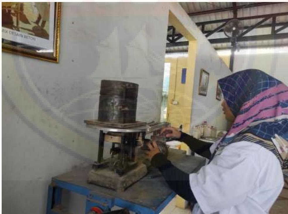
Proses Penimbangan Mold untuk Pengujian Berat Isi
