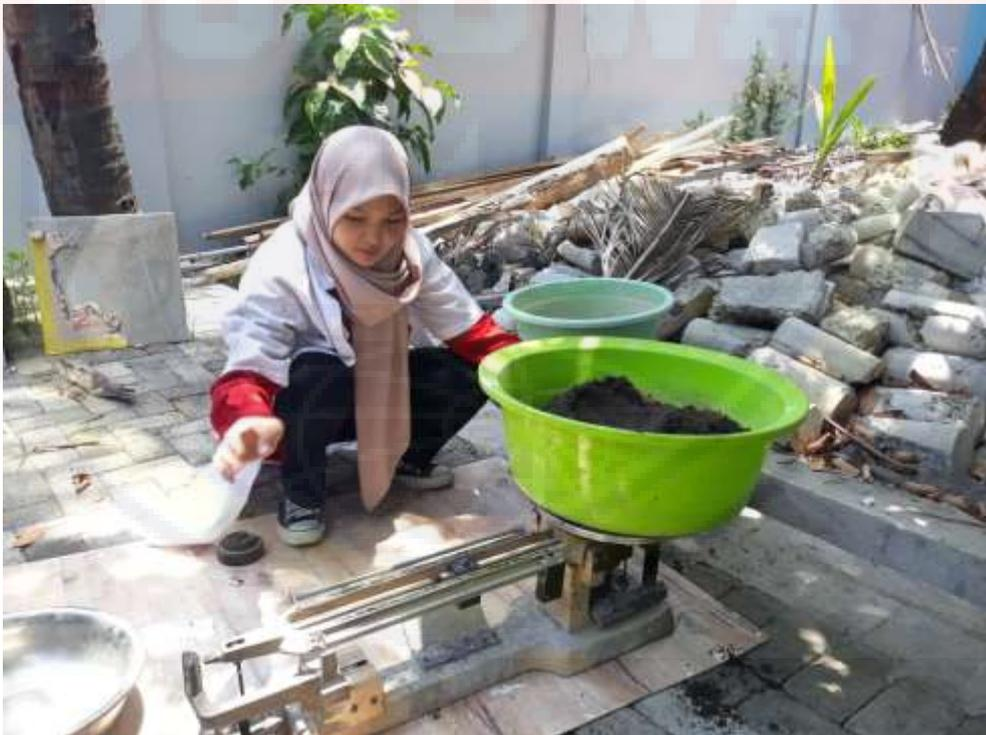
Proses Penimbangan Agregat untuk Pembuatan Campuran Beton
