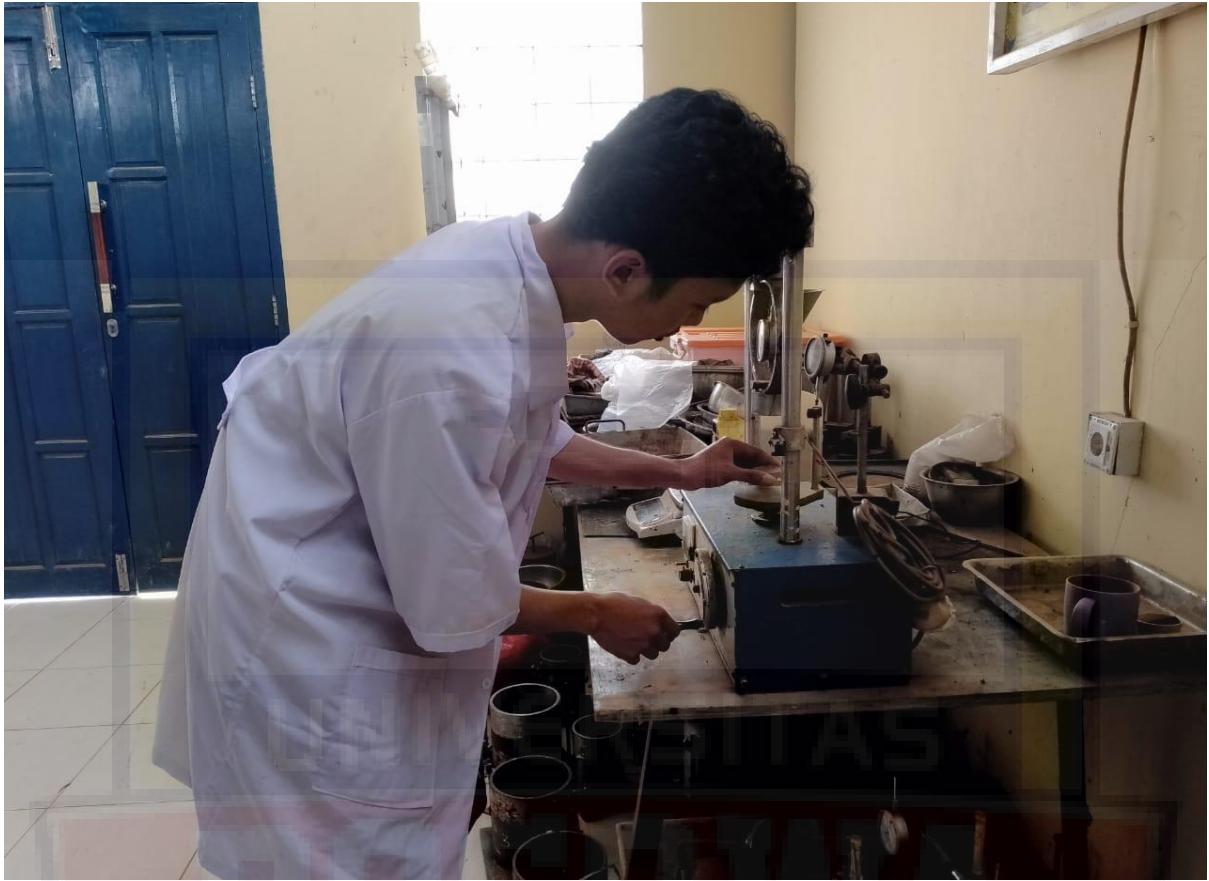
Pengujian Kuat Tekan.
