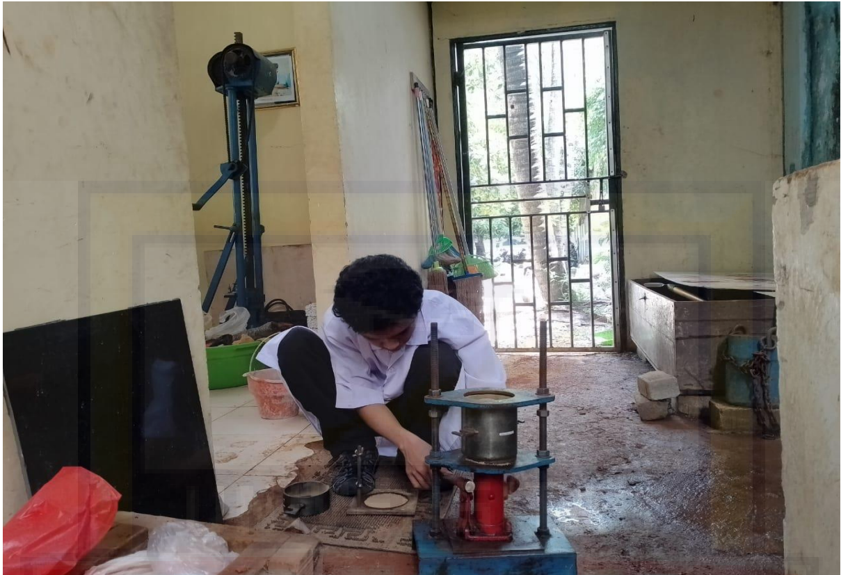
Mengeluarkan benda uji dari mould pada pengujian Kompaksi.
