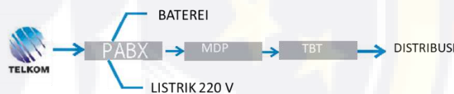
Gambar 4.26: Tahapan Instalasi Komunikasi
