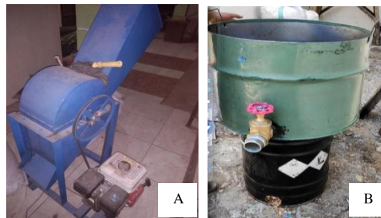
Gambar 5. A) Mesin pencacah plastic kapasitas 20 kg/jam, dan B) Model kompor dan panis pemanasan
