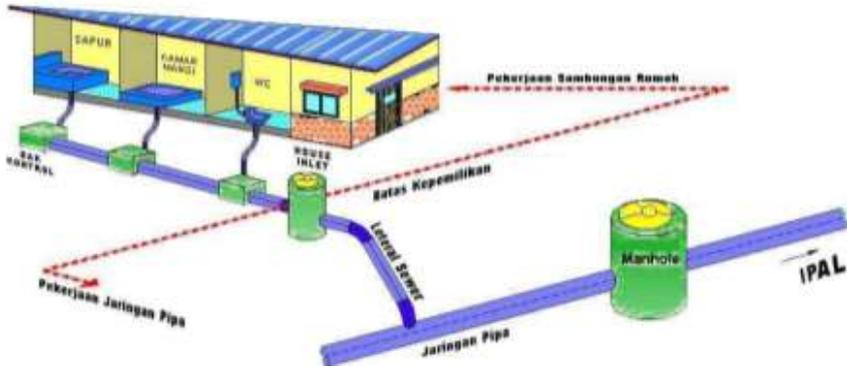
Gambar 2.1 Model Ringkas Sistem Sanitasi
