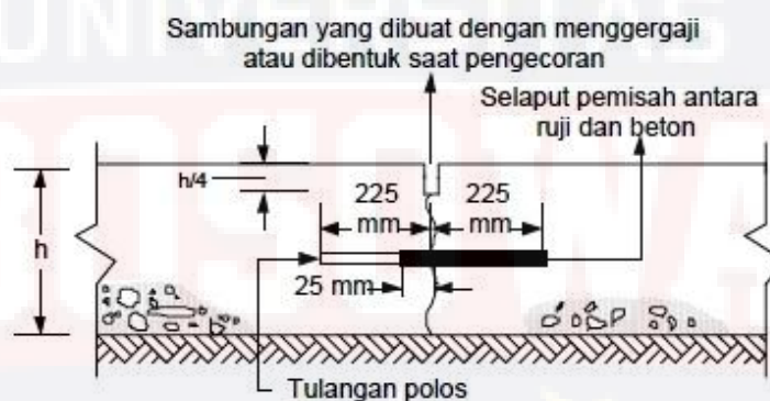
Gambar 2.5 Sambungan susut melintang dengan ruji
