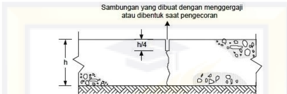
Gambar 2.4 Sambungan susut melintang tanpa ruji
