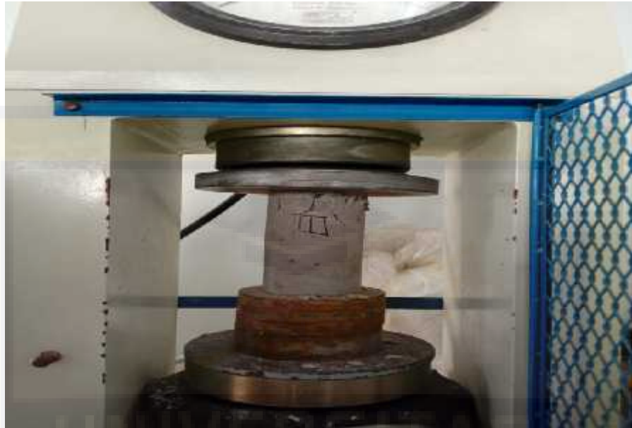
PENGUJIAN KUAT TEKAN BETON (SILINDER)
