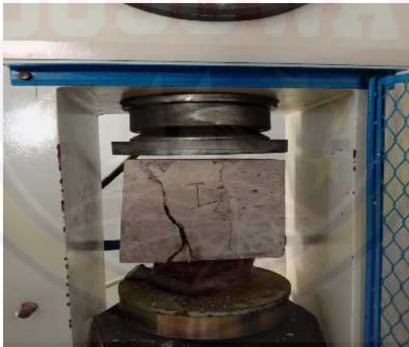
PENGUJIAN KUAT TEKAN BETON (KUBUS)
