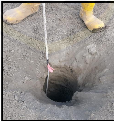
Gambar 2. 22 Pengukuran Kedalaman Lubang (PT. Petrosea Tbk)
