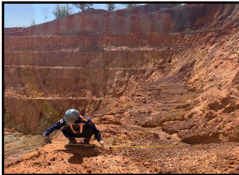
Gambar B. 6 Pengukuran geometri lereng bagian penampang Selatan
