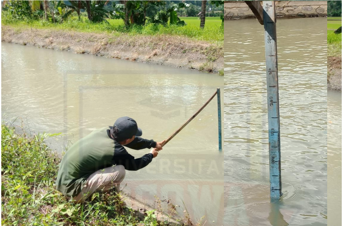
Pengukuran kedalaman air dari dasar saluran
