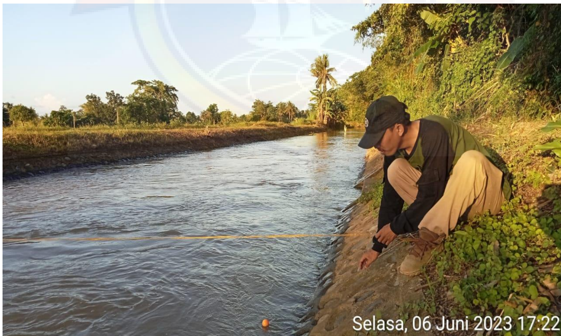
Pengukuran kecepatan arus menggunakan bola ping pong
