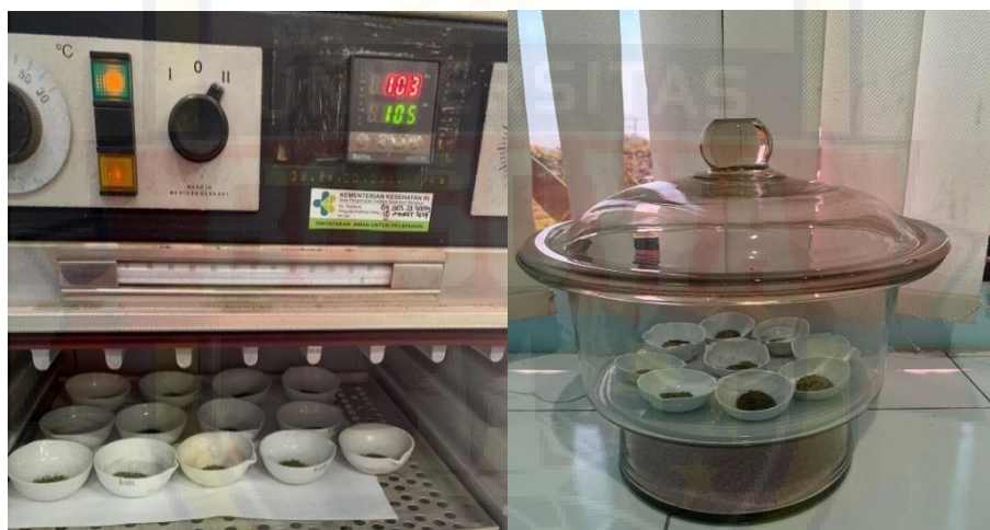
Gambar 11. Proses Analisis Kadar Air
