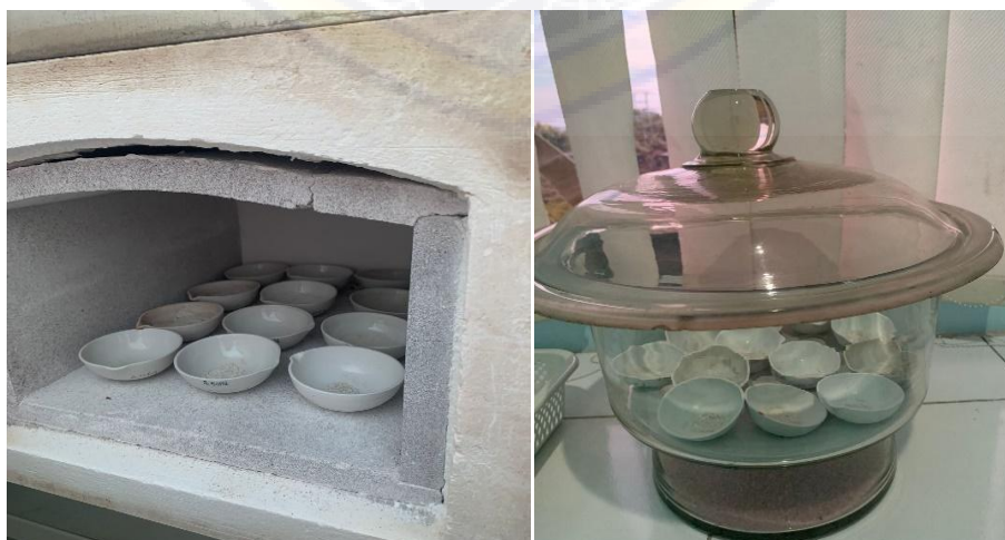
Gambar 12. Proses Analisis Kadar Abu
