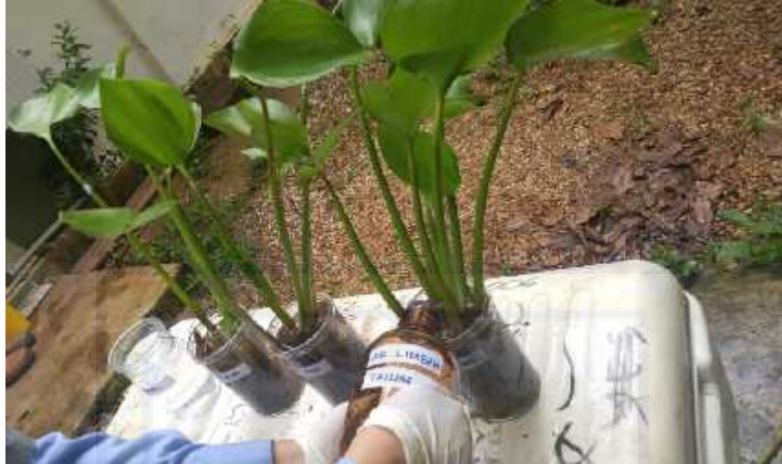
Gambar 3. Memasukkan 1 liter air limbah Tailing kedalam 3 wadah plastik yang sudah dibedakan massanya masing-masing.
