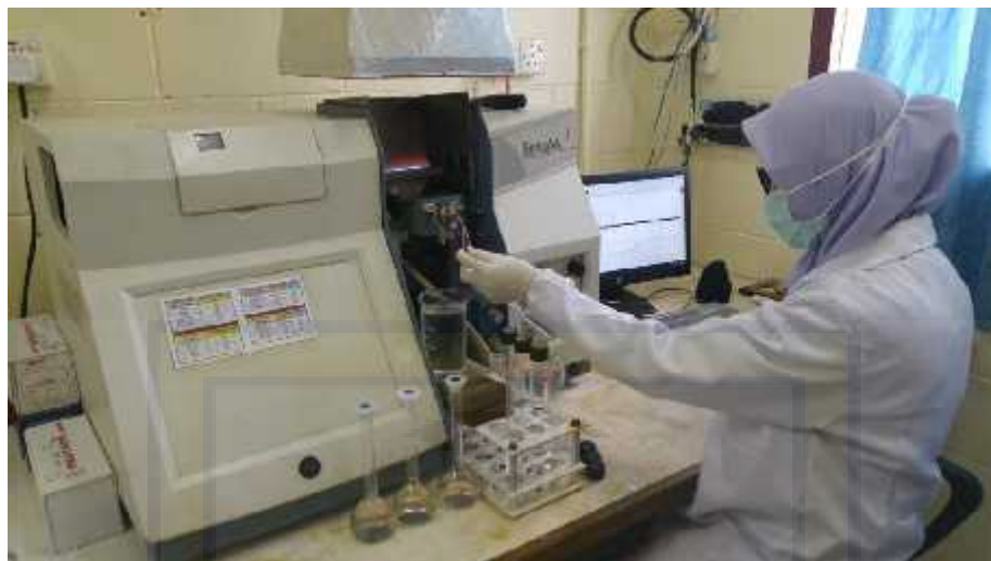
Gambar 11. Pengukuran contoh air limbah Tailing dengan AAS SensAA GBC Series
