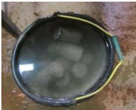
**Gambar 3.3.** Proses perawatan (*curing*) benda uji
