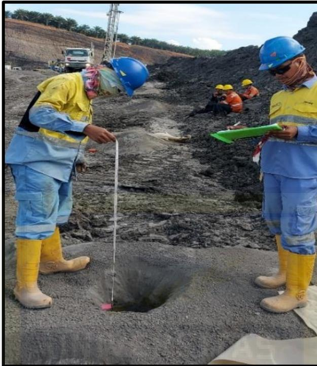
Gambar I.5 Pengukuran Kedalaman Lubang
